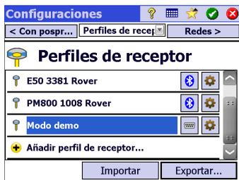
Después, cuando comience un levantamiento, solo tendrá que seleccionar el perfil de receptor deseado (y un *perfil de red* si trabaja en red; véase también *Administrar perfiles de red en la página 36*) antes de hacer que Survey Pro se conecte al receptor utilizado. Survey Pro configurará el hardware del receptor según los ajustes definidos en el perfil de receptor seleccionado.
