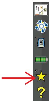
Esta herramienta ofrece un acceso directo para predeterminar las funciones/ rutinas de Survey Pro. Al pulsar en la estrella amarilla se accede directamente a una lista de funciones de Survey Pro (la lista *Selección rápida*). Simplemente presione uno de los elementos de la lista para ejecutar la función correspondiente.
