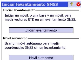
Si presiona **Captura datos** en el menú **Levantamiento** para trabajar con el receptor GNSS seleccionado sin haber iniciado primero un levantamiento, Survey Pro le invitará a elegir entre dos opciones:
