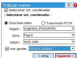
utilizará por defecto el modo **Calibración del terreno** para calcular las coordenadas de su cuadrícula a partir de las mediciones GNSS.
